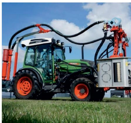
Der **VITipulse Combi** vereint Walzen- und Druckluftentlaubung und ermöglicht schnelles, schonendes Arbeiten.
