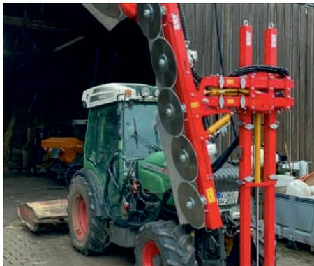
**BMV Konturschnittgerät:** (FL800T 5+3 Teleskop) mit Widiasägeblättern und alternativ Schlagmessern. Das Gerät kann an einen Fendt Vario Schmalspurschlepper angebaut werden und wird solo, mit Schlepper, oder als Komplett-dienstleistung angeboten.
